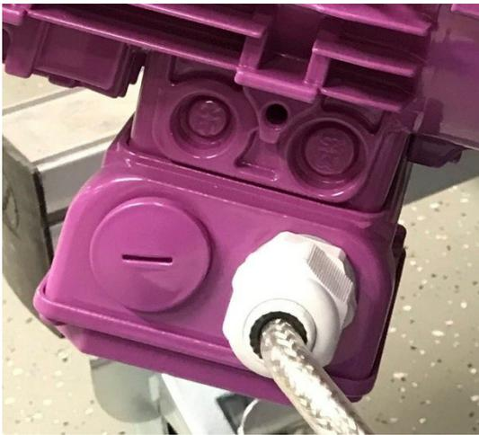
Abbildung 41: Beispiel-Klemmkasten mit Verbindungskabel
