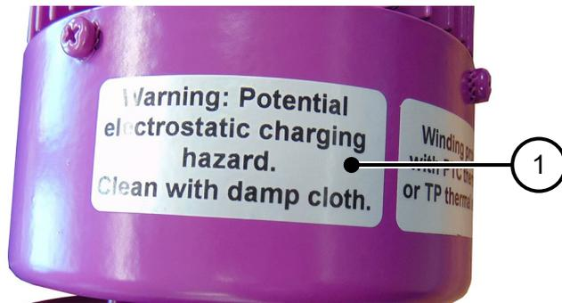
Abbildung 28: Aufkleber auf Lüfterradabdeckung - Mit feuchtem Tuch reinigen
