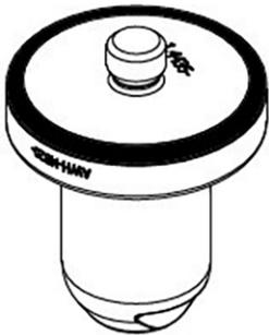
2. Feuchten Sie den O-Ring mit etwas Reinstwasser an.
