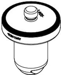
5. Drehen Sie den Lagerzapfen um, so dass der O-Ring nach unten zeigt.
