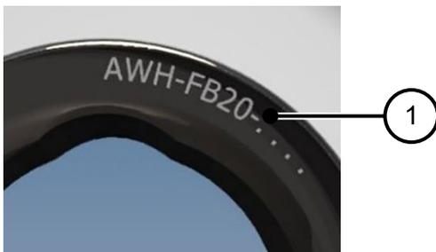
Abbildung 9: Kennzeichnung der Lagerbuchse
