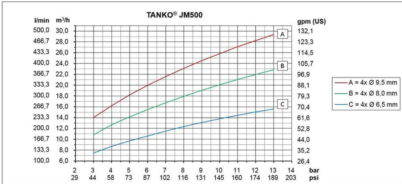
Abbildung 3.3-3: Diagramm - Durchfluss JM500-G22
