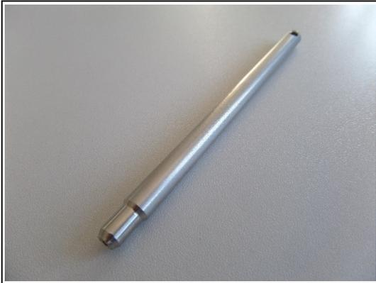
Montage-/Demontagewerkzeug für Sicherungsstift 2,4 mm (Clipon):
