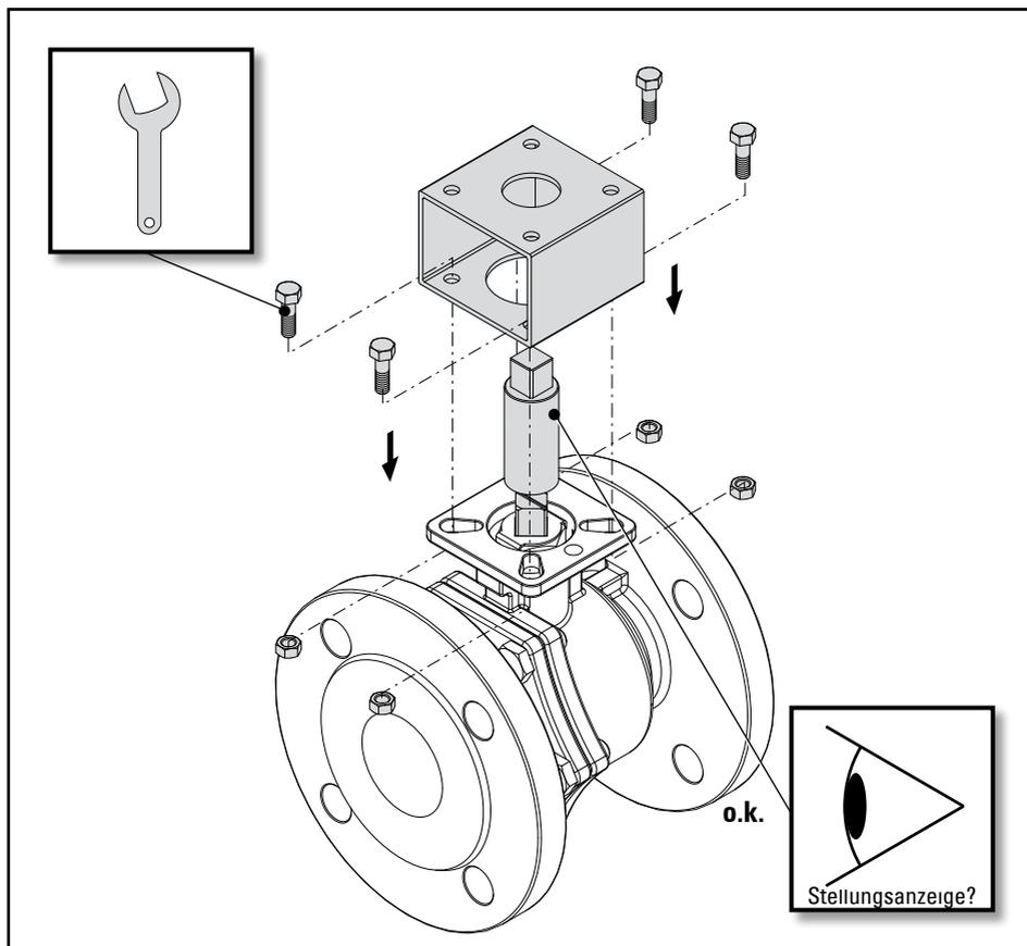
Abb. 6.2 - Einbau, Montage mittels Konsole und Spindel
