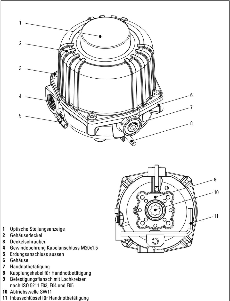
Abb. 4.1 - Äußere Bauteile NE03
