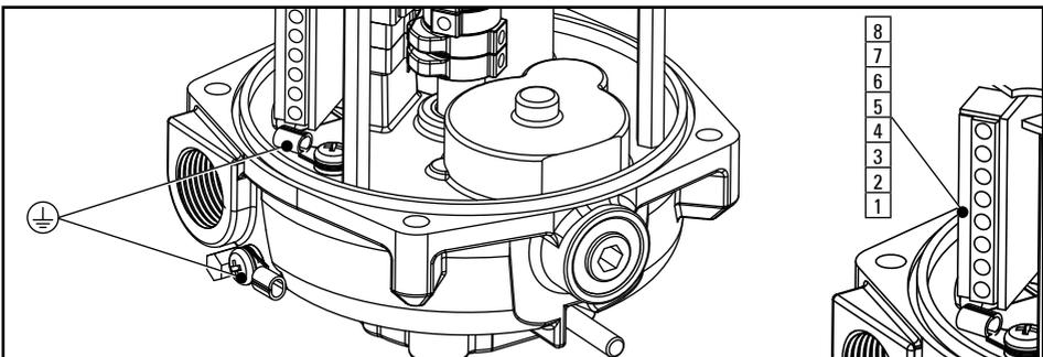
Abb. 6.5 -Elektrische Installation - Anschluss für Schutzleiter
