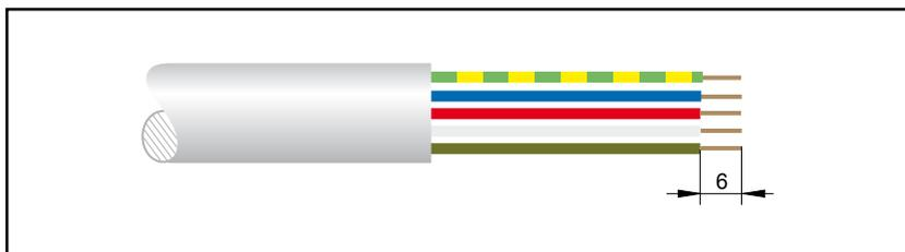
Abb. 6.4 - Elektrische Installation - Abisolieren der Kabel / Leitungen
