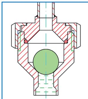
Bei Unterdruck fällt die Kugel durch die Schwerkraft in den unteren Dichtungssitz und verhindert so einen Abfall der Flüssigkeitssäule.
