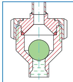
Bei sinkender Flüssigkeitssäule kann hier jedoch die Luft ungehindert an der Kugel vorbei nachströmen und somit den Aufbau eines Unterdruckes verhindern (belüften).
