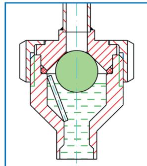
Bei steigender Flüssigkeit wird die aufschwimmende Kugel gegen den oberen Dichtungssitz gedrückt und schließt daraufhin automatisch.
