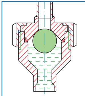
Bei steigender Flüssigkeit wird jedoch die aufschwimmende Kugel gegen den oberen Dichtungssitz gedrückt und schließt daraufhin automatisch.
