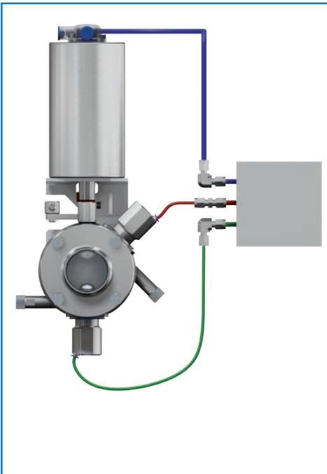
Bei der Nutzung von nur einer Steuerluftleitung sind bei geschlossenen Scheibenventilklappen die beiden Hilfsventile zur Spülung und Entleerung geöffnet.
