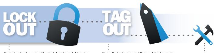
Beim **Lockout** werden **Verriegelungsvorrichtungen** an Energietrennungspunkten angebracht, um die Maschine auszuschalten und gegen Wiederinbetriebnahme zu sichern.
